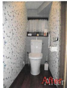
☆便所の改装・・・洋風便器の取替に伴い、模様替えを考えていると中山町のI様からのご連絡でした。便器はLIXILのイメージZで節水型の商品です。従来の1回分の水量は14Lが必要でしたが、今では5Lで十分で数年分の水道代で工事費用を賄えます。
